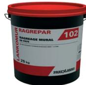
Pâte à mélanger avec un liant ciment PORTLAND. Enduit de ragréage destiné au rattrapage de planimétrie et au débouillage des voiles en béton. Il permet de réaliser un surfacage des supports et d'éliminer les défauts d'aspect des cueillies, coutures de banche ou nids de gravier (ségrégation).
